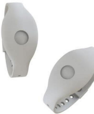
Figura 8 – Bracciale di localizzazione indoor
