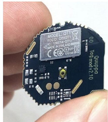
Figura 10 – Tag, sola elettronica, integrabile all'interno degli oggetti
