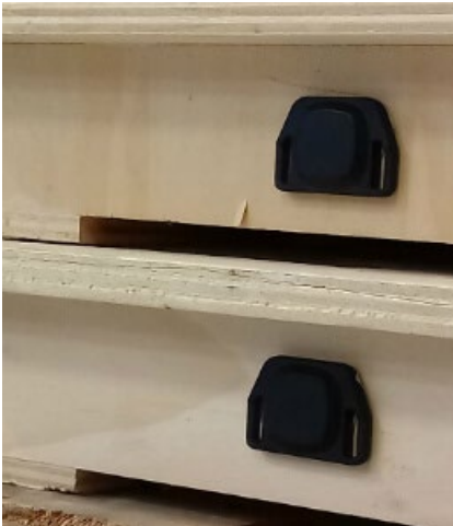
Figura 5 – Tag di localizzazione su pallet
